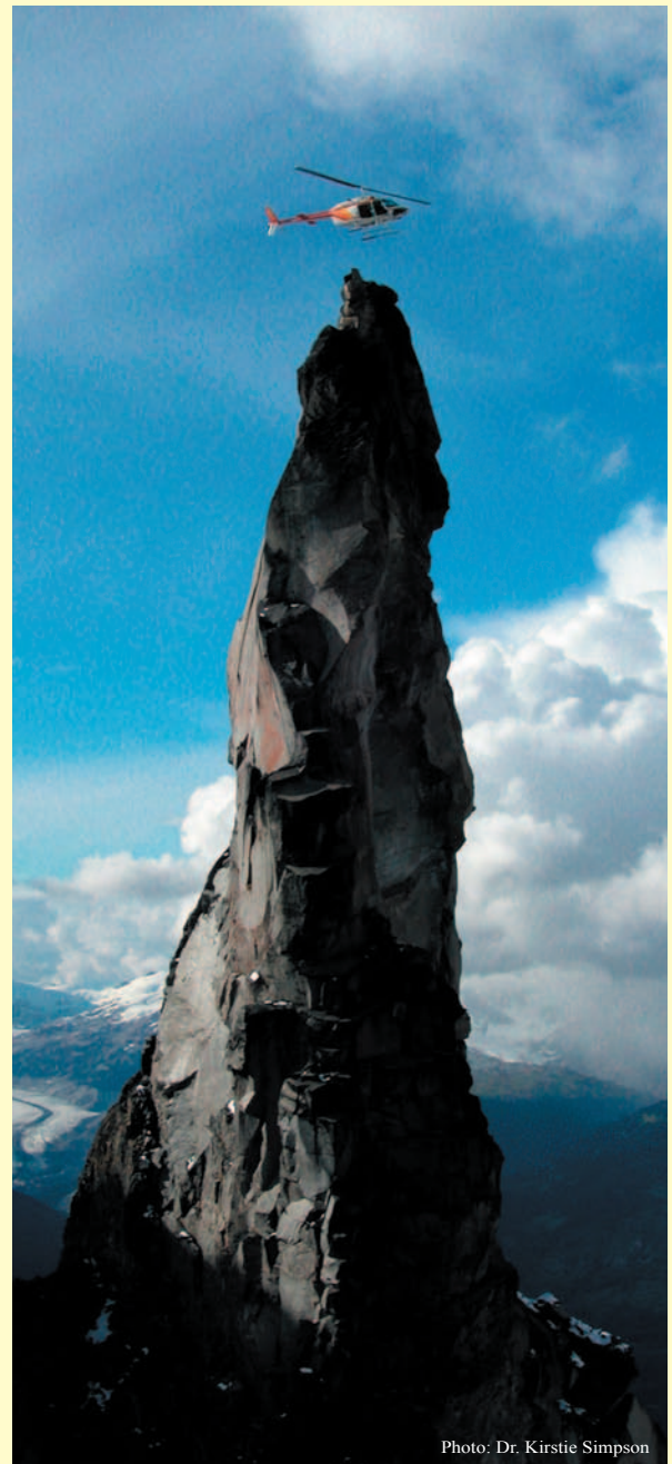
Figura 2: Helicóptero con la antena del GPS diferencial unida sobrevuela un afloramiento distintivo, usado como punto de control de tierra para la creación de un MDE. La colección de datos en este punto tomó cerca de 10 segundos.
