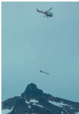
Figura 3. Sistema aeromagnético montado en un helicóptero.
